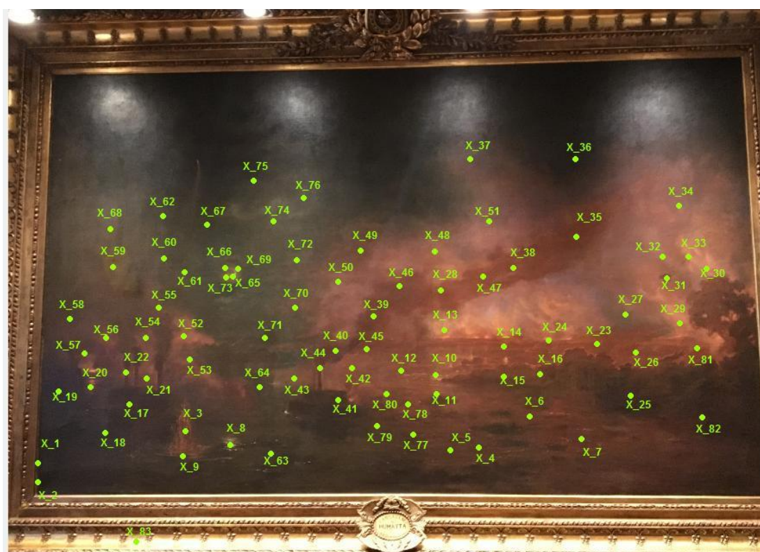
Fig. 5. Pontos onde foram registrados dados de XRF na obra “Passagem de Humaitá”. Fonte: Felix et al., (2021).
