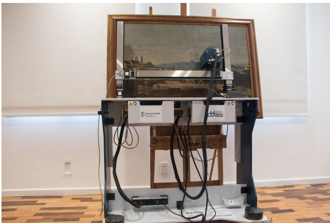
Fig. 7. Instrumento de MA-XRF operando no Museu Victor Meirelles Florianópolis/SC. Fonte: Autor.
