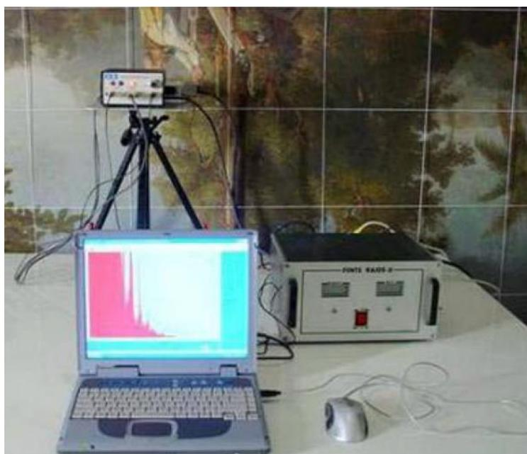
Figura 2 – Sistema portátil de XRF durante a análise do quadro
