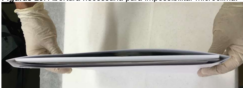
Figuras 29: Abertura necessária para impossibilitar microclima.
