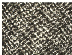
Imagem 3: Frente da jaqueta de senhora evidenciando a fibra da lã. Ampliação 7x.
