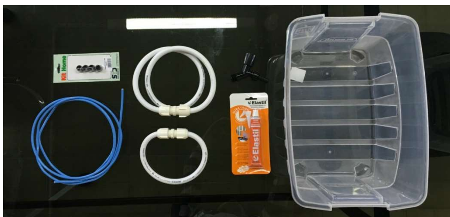
Figura 6: Peças utilizadas na confecção da caixa de lavagem e enxágue: borracha de apoio para cadeiras; fio rígido de aço emborrachado; mangueiras 1/2”; torneira 1/2”; silicone; caixa Plasutil 19L.
